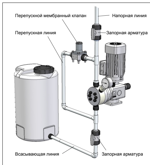
Рис. 21 Монтаж с (внешним) перепускным клапаном
