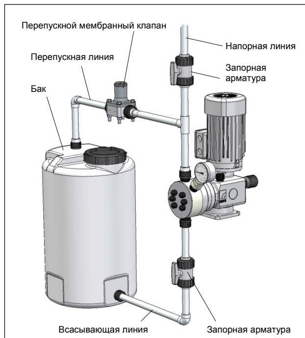
Рис. 20 Монтаж с (внешним) перепускным клапаном
