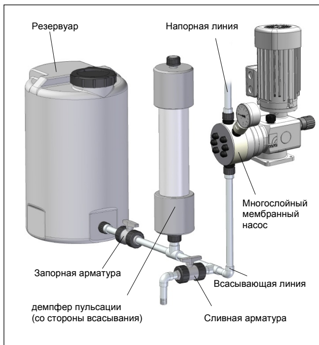
Рис. 31 Установка демпфера пульсации (II)
