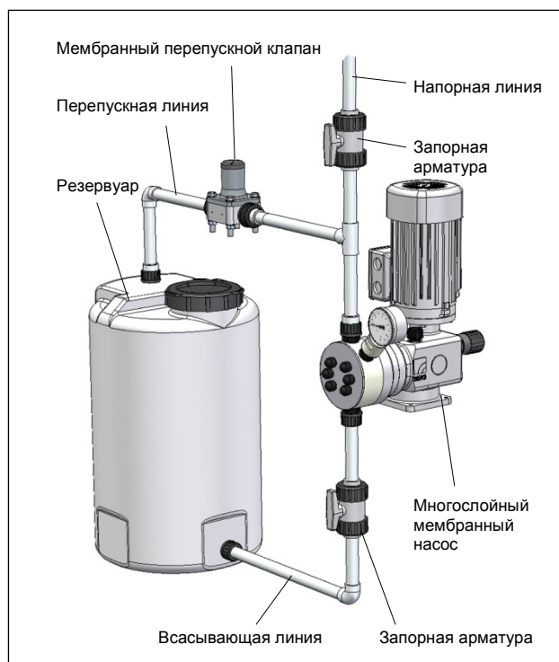
Рис. 20 Установка с (внешним) перепускным клапаном
