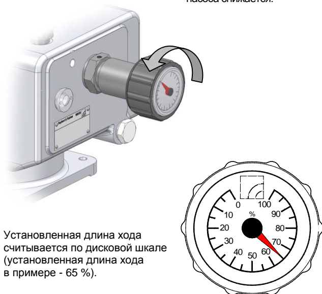
Рис. 12 Регулировка длины хода с индикатором положения
