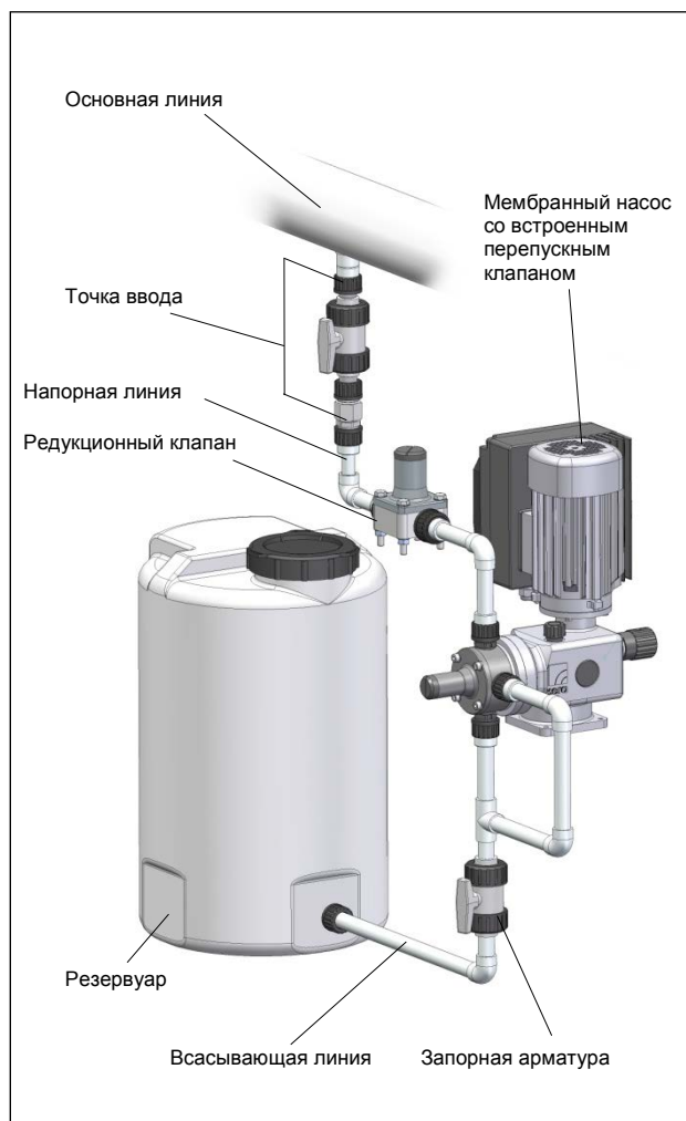
Рис. 27 Установка клапана поддержания давления
