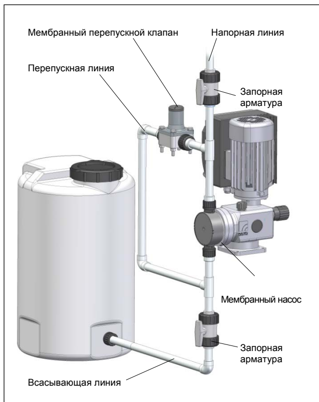
Рис. 24 Установка с (внешним) перепускным клапаном
