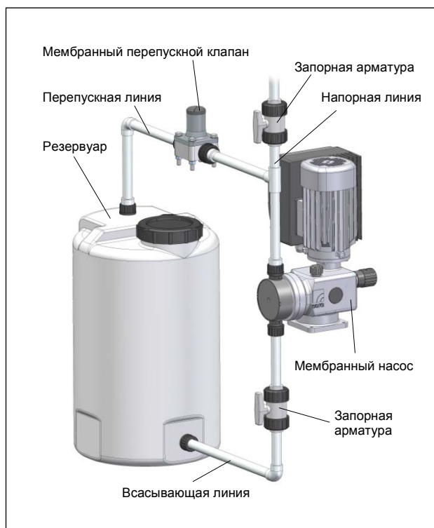
Рис. 22 Монтаж с (внешним) перепускным клапаном
