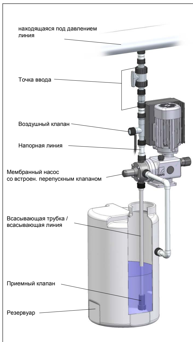
Рис. 28 Установка клапана обезвоздушивания
