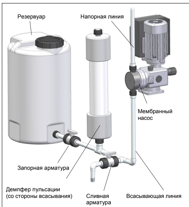
Рис. 36 Монтаж демпфера пульсации (II)
