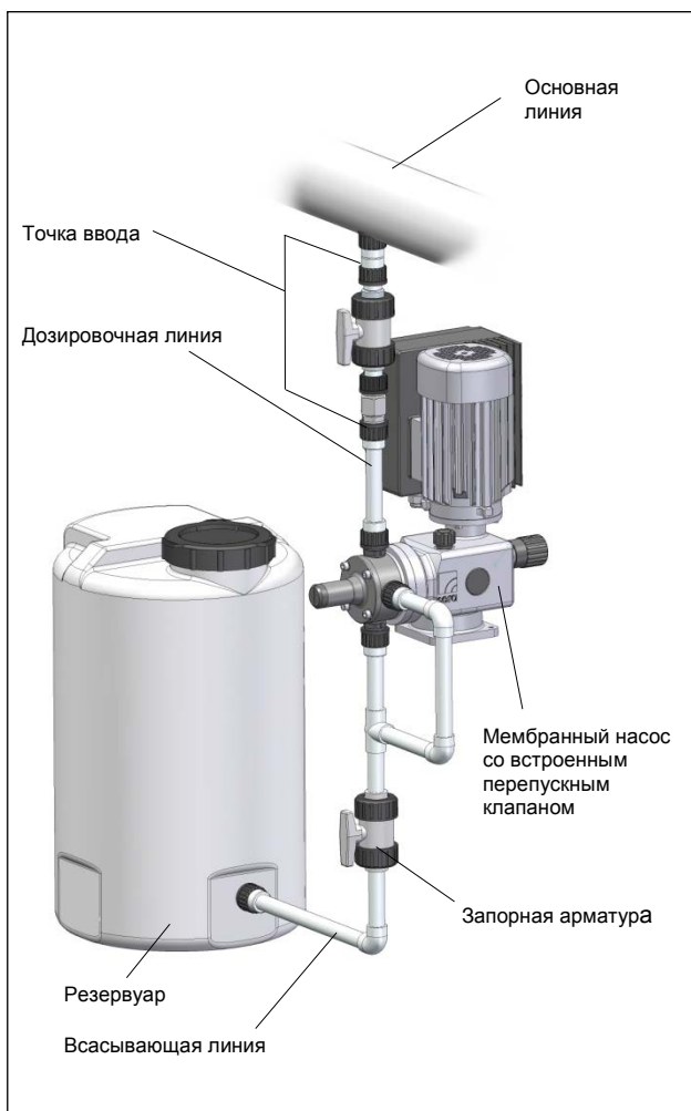
Рис. 26 Установка точки ввода
