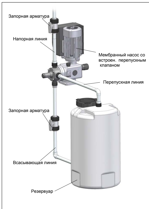
Рис. 23 Монтаж со встроенным перепускным клапаном
