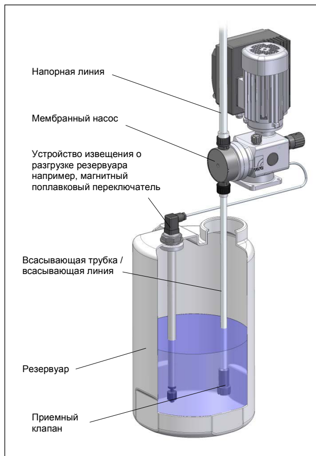
Рис 35 Монтаж устройства извещения о разгрузке резервуара
