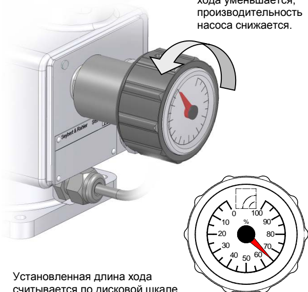
Рис. 15 Регулировка длины хода с индикатором положения
