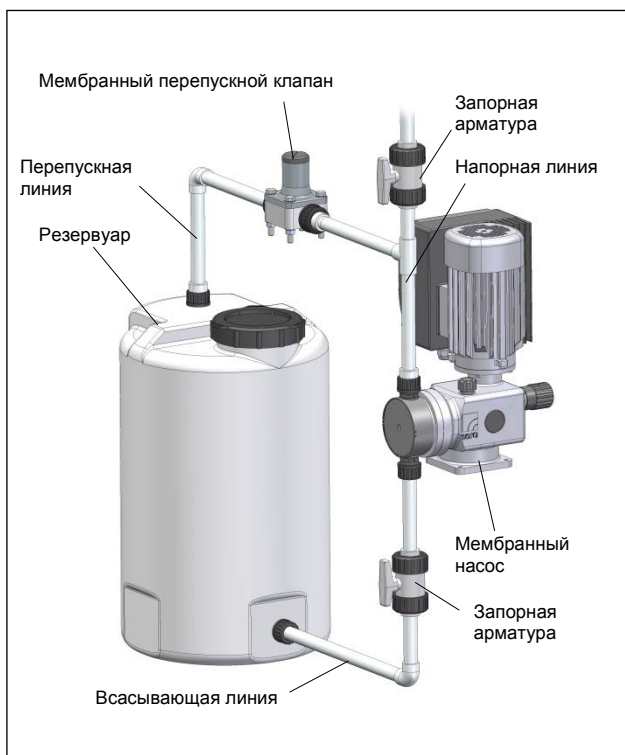
Рис. 27 Монтаж с (внешним) перепускным клапаном
