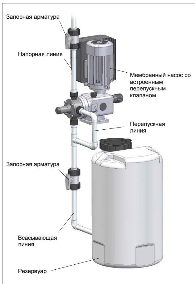
Рис. 30 Монтаж со встроенным перепускным клапаном
