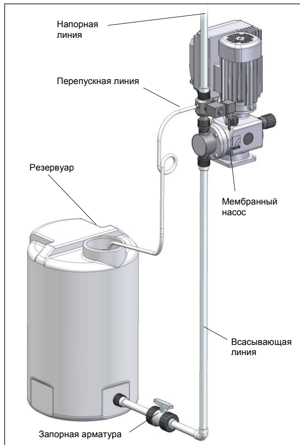
Рис. 40 Установка мембранного насоса с автоматическим удалением воздуха
