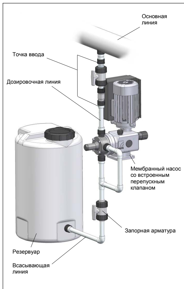
Рис. 31 Установка точки ввода
