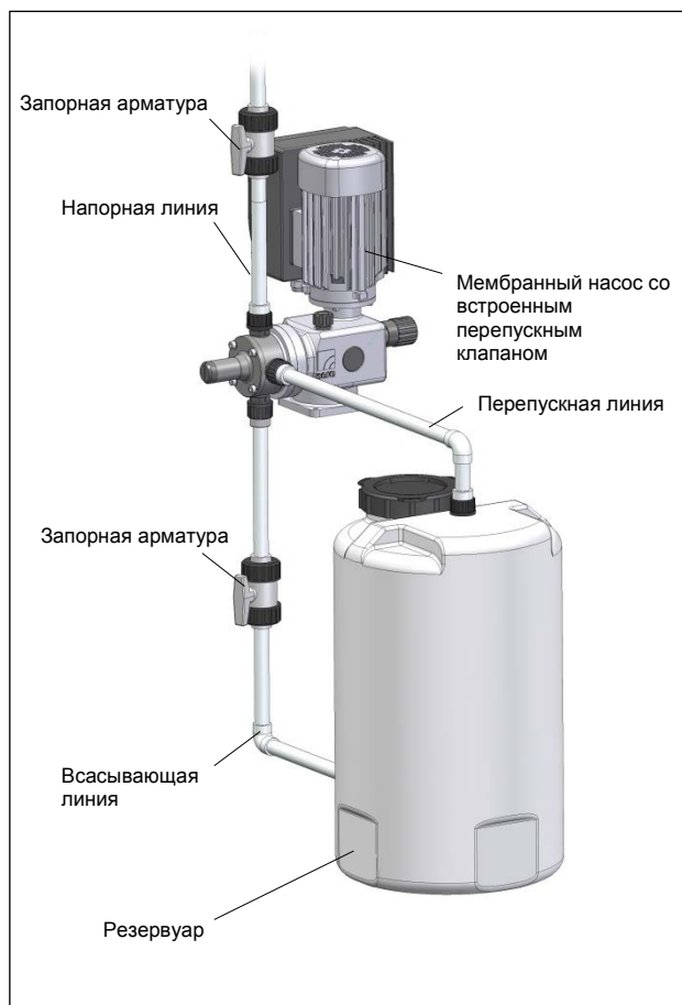
Рис. 28 Монтаж со встроенным перепускным клапаном
