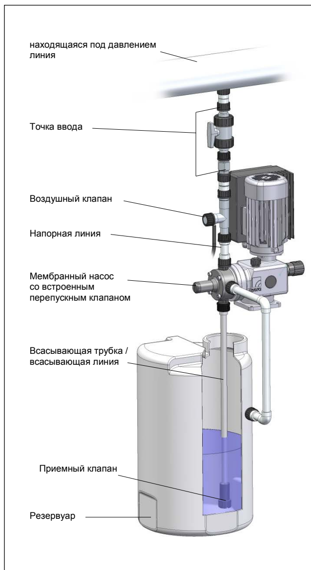
Рис. 34 Монтаж воздушного клапана
