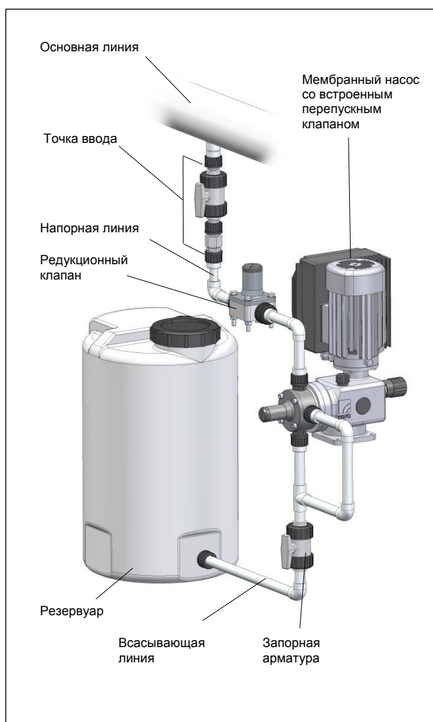
Рис. 32 Монтаж редукционного клапана
