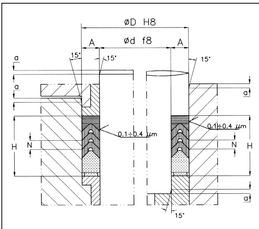
Классическое гидравлическое уплотнение для прямолинейного движения, применяемое как для масляных, так и для водных гидравлических систем. Симметричный профиль позволяет использовать тип UN в качестве уплотнения штоков и поршней при рабочих давлениях до 350 бар.
